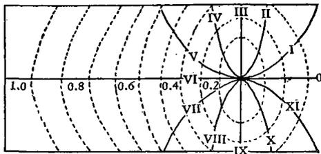
图 2  $\mu = 0$  时半日分潮的同潮时綫(实綫, I~ $30^\circ$ , II~ $60^\circ$ )与等振幅綫(虚綫, 用厘米表示)
