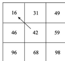
图 3 最陡坡度确定水流方向的示意图
