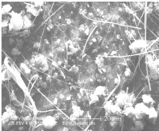
图 1 TSP 中粒子的 SEM 照片
