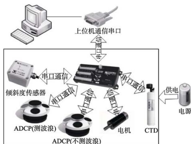
图 1 海洋剖面测量平台控制系统示意图
